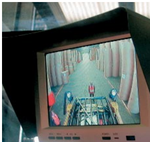
Blick auf den Monitor in der Fahrerkabine
