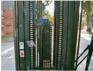
Schlechte Sicht durch ungünstige Gestaltung des Hubgerüsts
