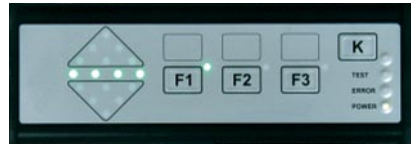
Anzeige der Einfahrtiefe
