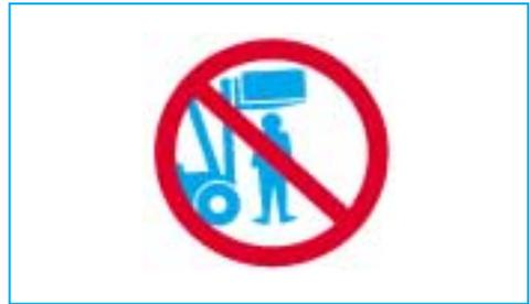
An einem Gabelstapler mit mehr als 2000 mm Hubhöhe ist ein dauerhafter und leicht erkennbarer Anschlag angebracht mit dem Hinweis:
