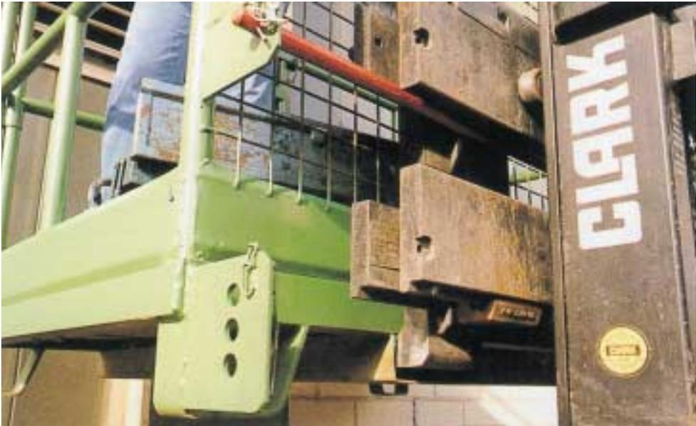
In solchen Fällen dürfen Personen nur auf- und abwärts gefahren werden, wenn am Lastaufnahmemittel eine Arbeitsbühne mit Geländer, Knieleiste und Fußleiste sicher angebracht ist. Sie ist dann sicher angebracht, wenn sie von den Gabelzinken weder abrutschen noch abkippen kann.
