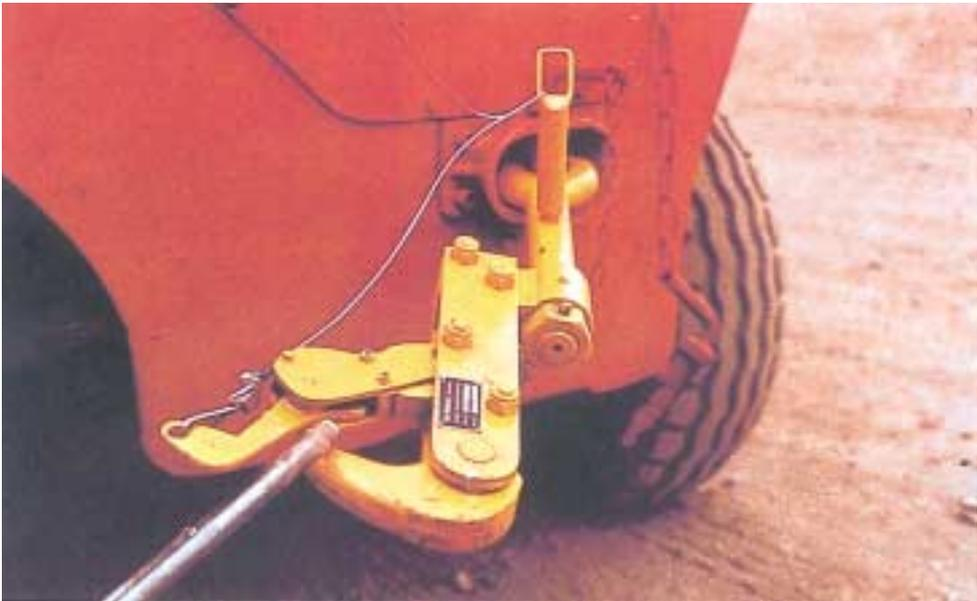
Das Waggon-Rangiergerät ist ein Zusatzgerät für Gabelstapler ohne eigenen Antrieb. Es wird mit den Gabeln des Staplers aufgenommen, am jeweiligen Einsatzort auf die Schienen gesetzt und an den Waggon gekuppelt. Über die klappbare Rampe fährt der Stapler dann auf das Rangiergerät.
