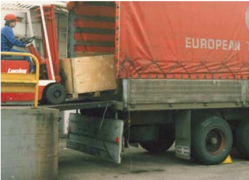
Das Entladen der LKWs mit dem Gabelstapler erfolgt meist von einer Seite aus. Um auch den an der gegenüberliegenden Bordwand stehenden Materialbehälter mit Inhalt sicher und ohne Schaden abladen zu können, werden vom Fachhandel hydraulisch betätigte, von der Hubgabel geführte und nach vorne bewegliche Schubgabeln angeboten.
